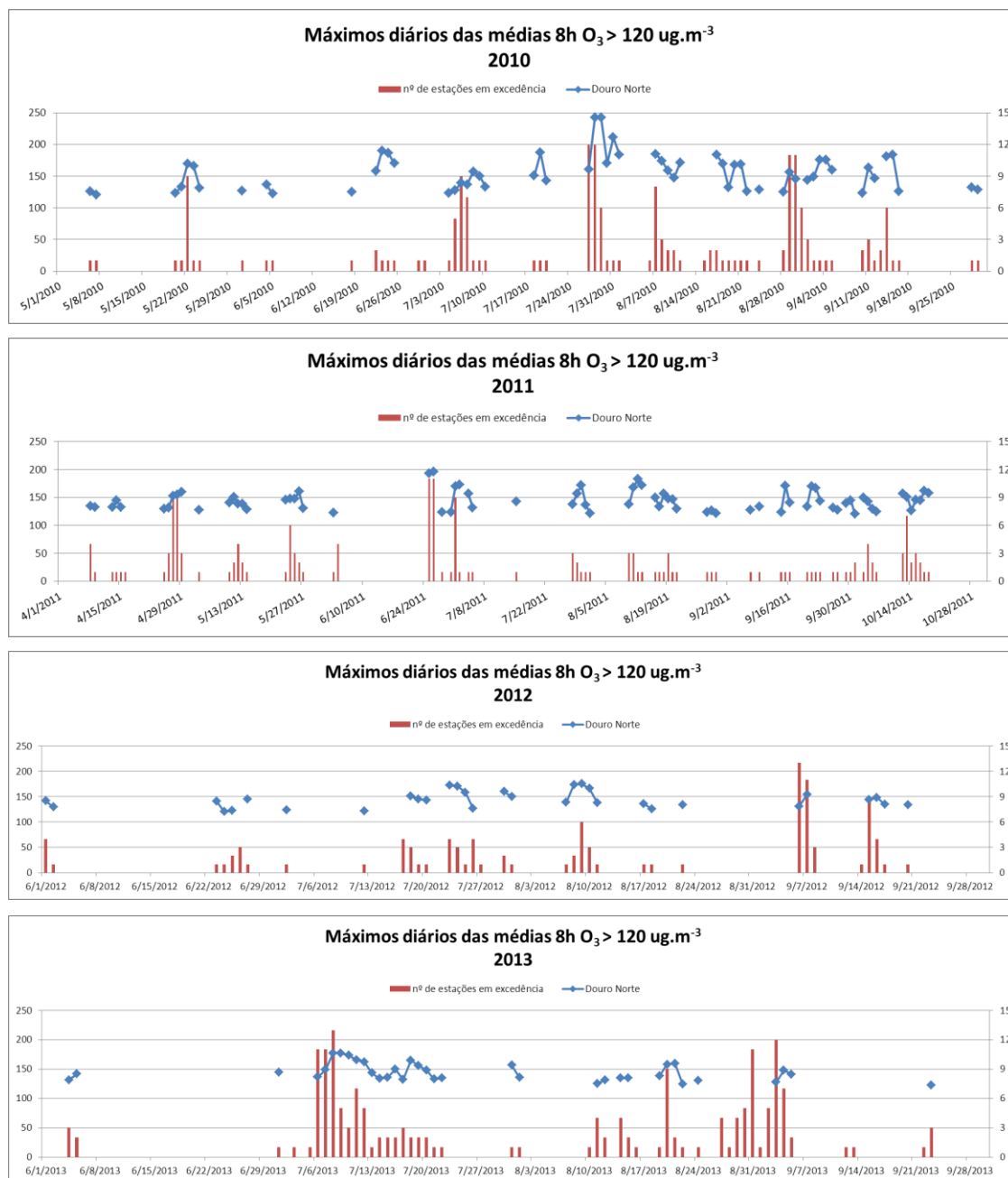
Figura 2. Máximos diários das médias de 8h superiores a 120 \mu\text{g.m}^{-3} (VA) registados na estação de Douro Norte (linha azul) e o número de estações em que ocorreram excedências ao VA simultaneamente (barras a vermelho).
